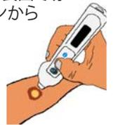
(4) すると、照準ライトが点滅し、ディスプレイに対象物の表面温度が表示されます。
